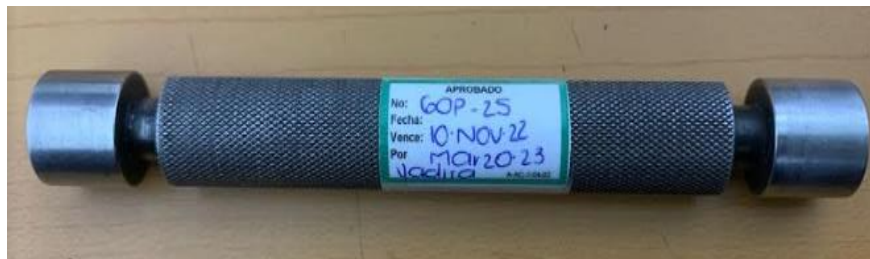
Figura 4.7 Gauge con tarjeta de calibración actualizada.
